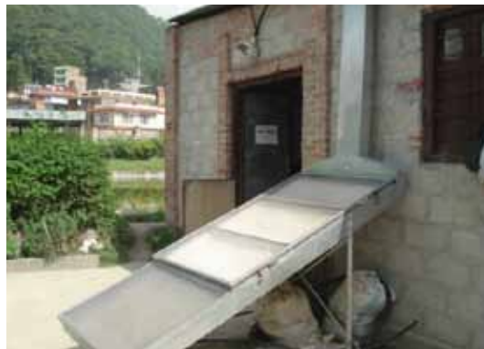
चित्र नं. १ भिङ्गे माछा पखाल्दा बालुवा निस्केको | चित्र २ भिङ्गे माछा सुकाउने सोलार ड्रायर
